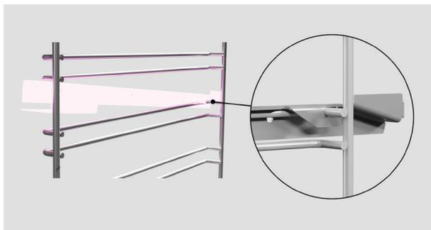
2. Asegúrese de que las pestañas traseras estén enganchadas a las rejillas laterales en ambos lados.
