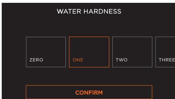
3. Seleccione el nivel de dureza del agua correspondiente y luego presione CONFIRMAR.
