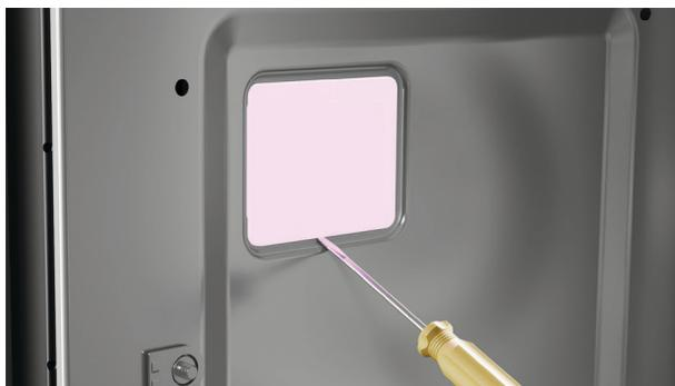
2. Utilice un destornillador de punta plana para levantar con cuidado la cubierta de vidrio de la bombilla.
