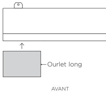
Insérez les deux revêtements de pattes dans la plinthe en vous assurant que le long bord rabattu soit orienté vers l'intérieur du produit.
