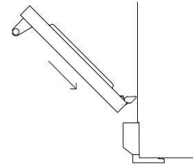
En maintenant la porte à 45°, alignez soigneusement les languettes de charnières avec les fentes de charnières. Poussez la porte vers l'intérieur jusqu'à ce que les verrous soient bien en place de chaque côté.
