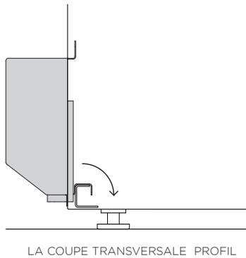
Alignez la plinthe avec les panneaux latéraux de la cuisinière. Enclenchez la plinthe en la pivotant et en appuyant le support sur la structure de la cuisinière.
