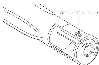
Chaque valve et obturateur d'air est testé et réglé individuellement avant l'expédition. Aucun ajustement n'est normalement requis; toutefois, les vibrations en cours de transport, la conversion du type de gaz ou les variations au niveau de l'alimentation en gaz locale peuvent rendre nécessaires certains réglages mineurs.
