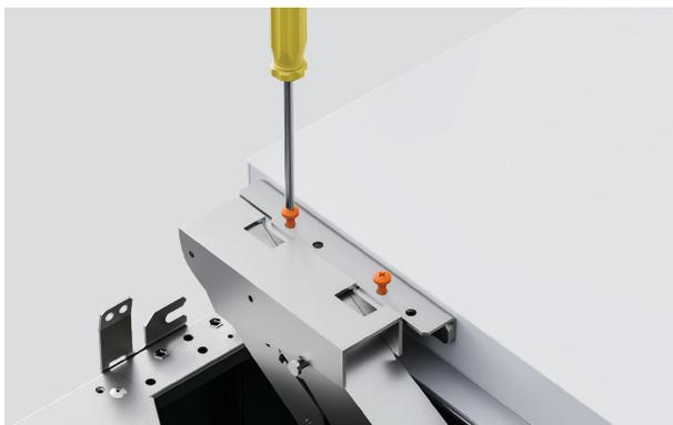
2. Staccare la porta dall'apparecchio svitando le viti esagonali M6x10 (4x) della cerniera superiore e della cerniera inferiore/centrale.
