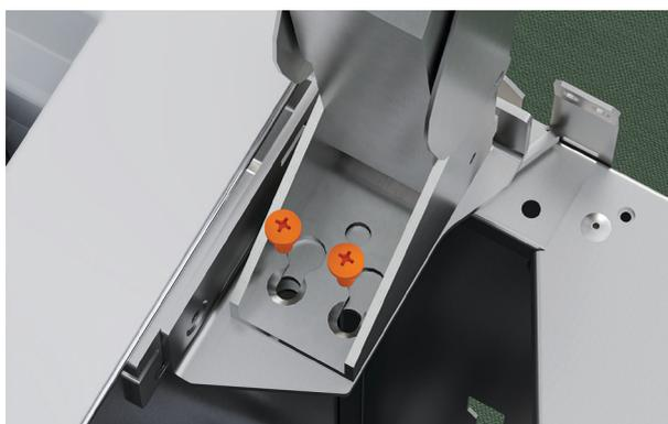
2. Inserire la cerniera superiore rimossa nelle linguette della staffa inferiore. Ruotarla in posizione e fissarla con due viti svasate M5x12.
