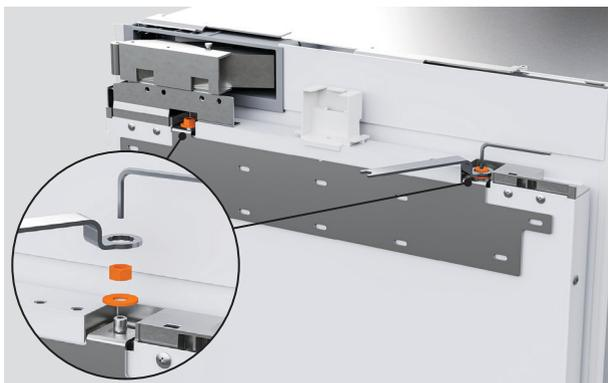
1. Rimuovere il dado M8 e la rondella M8 dalla vite M8 nella parte superiore della porta utilizzando la chiave esagonale e la chiave in dotazione.
