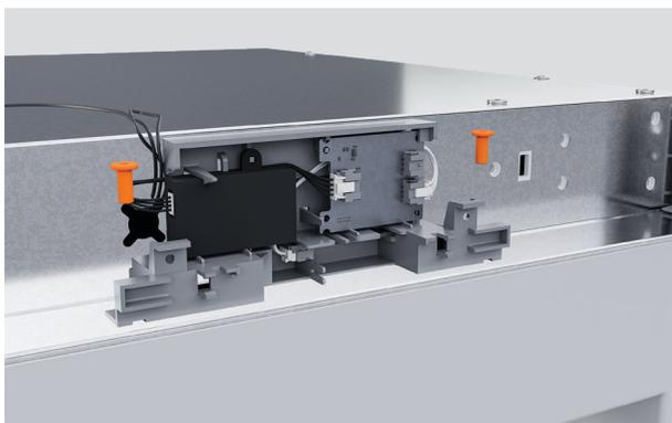
**5.** Reinstallare l'alloggiamento del sensore utilizzando due viti #8x16 nei fori preforati nel pannello superiore del mobile.
