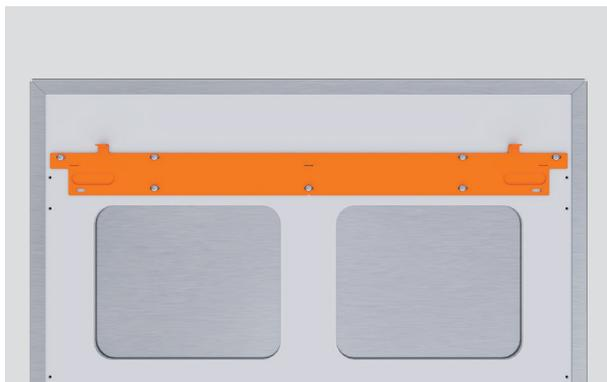
**5.** Fissare la staffa di sospensione superiore ai fori per le viti del pannello porta con viti M5 x 12 PH.
