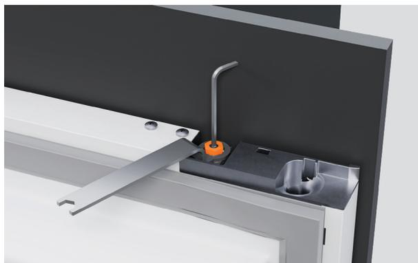
5. Stringere leggermente le viti laterali e le rondelle M8 superiori usando la chiave esagonale e la chiave a L fornite nel kit di installazione.
