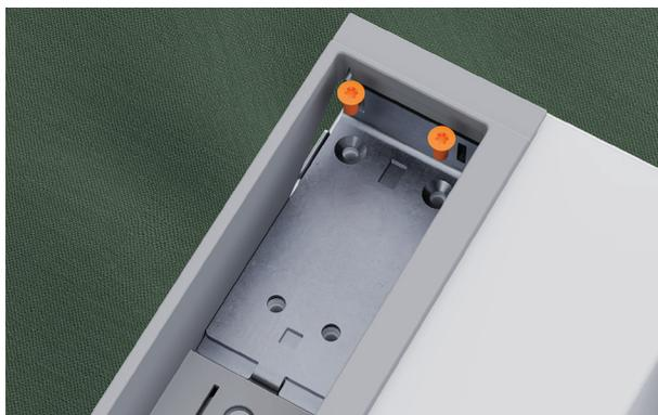
1. Reinstallare la staffa della cerniera superiore e il distanziatore della staffa con viti svasate M5x12 sul nuovo lato della cerniera.
