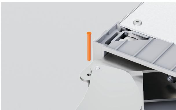
1. Per limitare l'apertura della porta ad un massimo di 90°, inserire il perno bloccante all'interno della cerniera superiore e inferiore.
