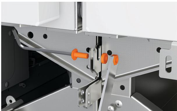
**2.** Fissare le staffe inferiori insieme utilizzando la vite M6 e il dado in dotazione. Fissare utilizzando una chiave allen da 4 mm e una chiave da 10 mm. Assicurarsi che le staffe siano bloccate saldamente prima di procedere.
