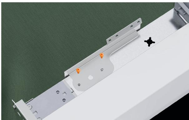
5. Per il lato senza cerniera, montare una nuova staffa per nicchia utilizzando viti svasate M6x16.
