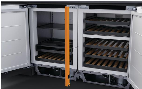
1. Ubique la moldura central entre los productos y empújela para que calce en su posición. Asegúrese de que la parte inferior de la moldura no tape la rejilla.
