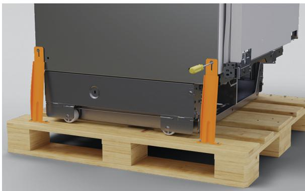
3. Con un destornillador Phillips, retire los pernos para transporte de un lado del producto y apártelos.
