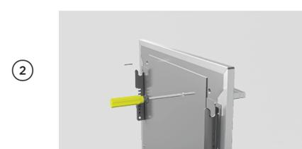
Inserire le viti in dotazione dalla parte posteriore del pannello.
