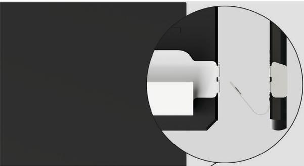
5. 在重新安装第二块中玻璃板时，确保金属支架位于玻璃板底部的正确位置。
