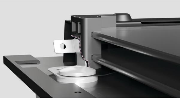
4. 把玻璃板放入门里，橡胶止动块落在外玻璃板上。
