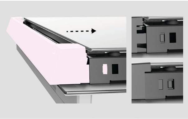
3. 重新安装玻璃固定板，确保玻璃固定板卡到位。
