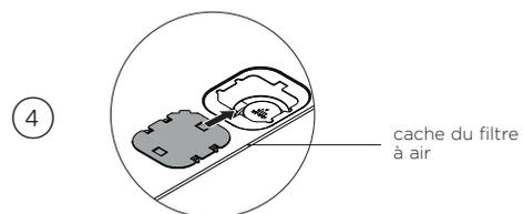
Faites glisser le cache du filtre à air sur l'ouverture du filtre à air.
