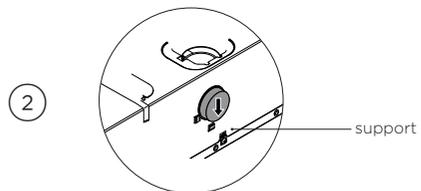
Insérez le bouchon verrou dans le support.
