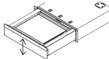
Ajustez à la hauteur requise, puis resserrez les vis. La hauteur est réglable sur 5 mm.
