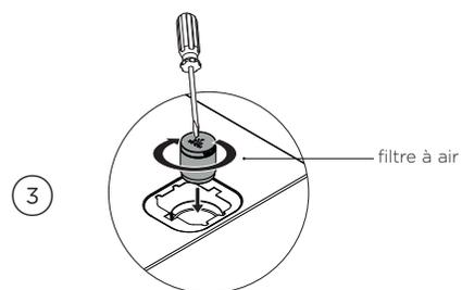
Utilisez un tournevis à fente pour visser le filtre à air dans l'ouverture du filtre à air.
