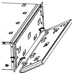
Assurez-vous que l'attache inférieure de réglage est enclenchée à l'extérieur du tiroir, entre la vis et le tiroir.
