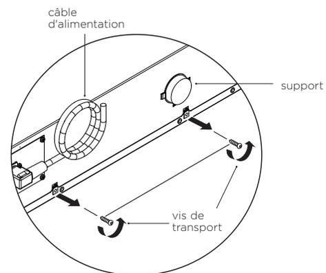
Dévissez les vis de transport sous le câble d'alimentation et le support.
