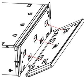
Alignez les languettes du panneau sur le châssis et assemblez les pièces.
