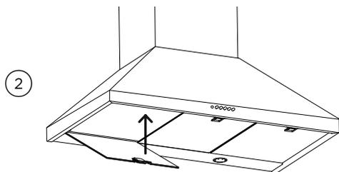
Placez le filtre dans le support à l'arrière de la hotte. Poussez le filtre pour le remettre en place.
