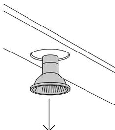
Remplacez l'ampoule par une nouvelle ampoule dont la puissance n'est pas supérieure.
