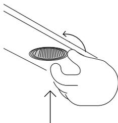
Poussez légèrement l'ampoule vers le haut, puis tournez-la dans le sens contraire des aiguilles d'une montre pour la retirer.
