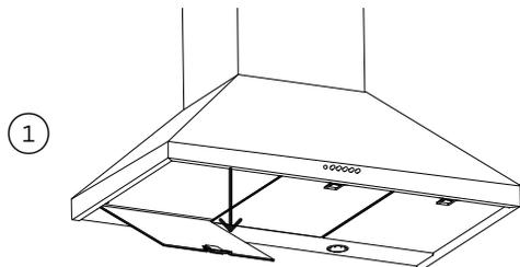
Tirez sur le loquet et inclinez le filtre vers le bas jusqu'à ce qu'il se désengage des supports.
