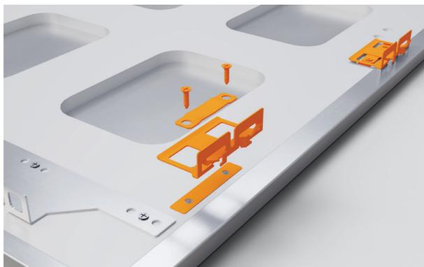
4. Aligner les supports latéraux sur le panneau. Les fixer à l'aide des vis fournies. S'assurer que les supports sont bien ajustés et que les fixations sont bien droites.
