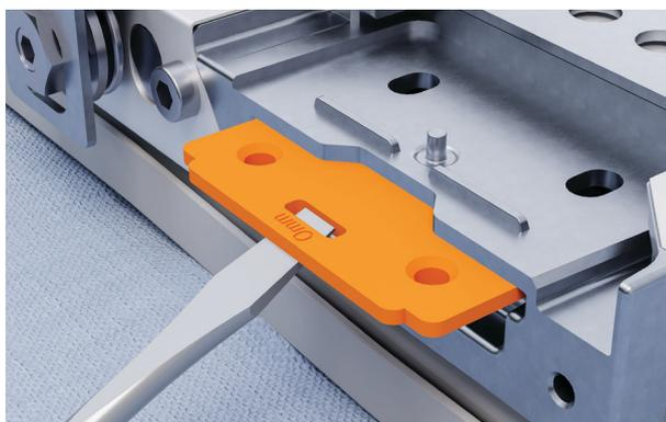
6. Utiliser un tournevis plat pour retirer les plaques intérieures. Les tourner dans l'autre sens en veillant à ce que les coins arrondis soient tournés vers l'intérieur.
