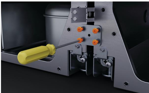
2. Fixer le support inférieur avant à l'aide de quatre vis.
