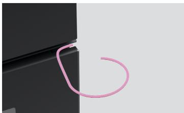
Inserte con cuidado la herramienta para abrir la puerta en la parte superior derecha del horno, entre la rejilla central y la parte superior de la puerta.
