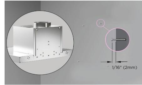
Installez les vis de montage du capot supérieur de 1 3/16 po (30 mm)\* conformément à la page des dimensions du produit. Assurez-vous que les deux vis font saillie de 1/16 po (2 mm).
