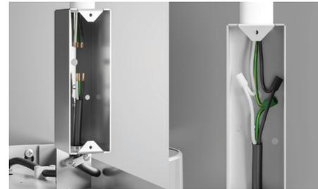
Retirez le débouché électrique. Installez un conduit de câblage de 12,7 mm (1/2") homologué UL et une décharge de traction dans la boîte de jonction.
