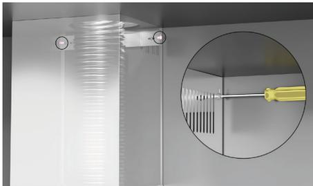
Étendre la cheminée supérieure et fixer au support de cheminée supérieur à l'aide de deux vis cruciformes 3/8 po (10 mm).
