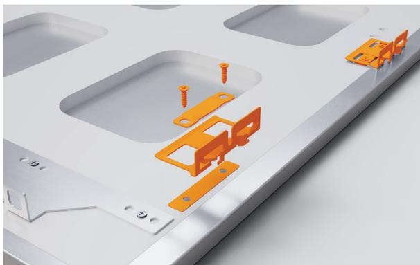
4. Allineare le staffe laterali al pannello. Fissare utilizzando le viti in dotazione. Assicurarsi che le staffe siano fissate saldamente e che gli elementi di fissaggio siano stretti.
