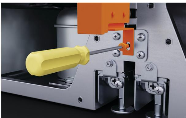
3. Assicurarsi che la parte alta del profilo tocchi la nicchia prima di fissarne la posizione con gli elementi di fissaggio in dotazione.
