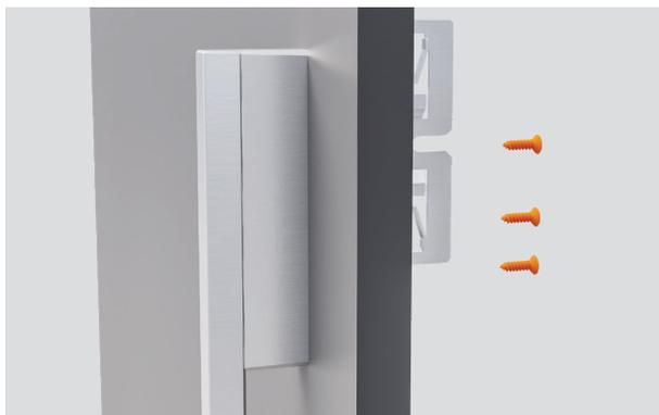
7. Montare la maniglia sui pannelli utilizzando quattro viti esagonali M5x25. Accertarsi che i punti di fissaggio della maniglia non interferiscano con le staffe laterali.
