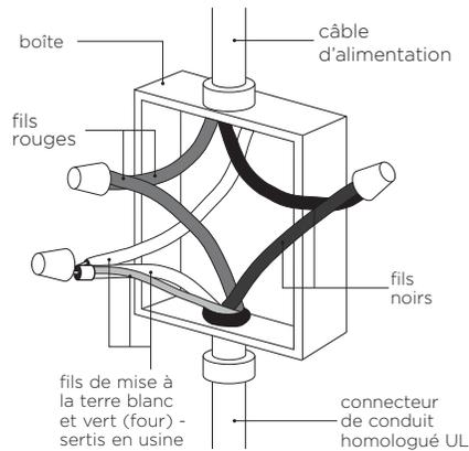
**Si les codes locaux permettent de raccorder le conducteur de mise à la terre du module au fil blanc (neutre) de la boîte de jonction :**
