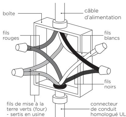
**Si vous raccordez l'appareil à un système électrique à quatre (4) fils :**
