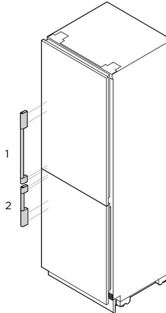
M5 X 25mm 盘头内六角螺钉 (每个手柄 4 个) 适用于标准 19 毫米面板。
