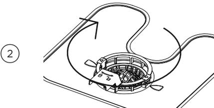
Remplacez le filtre de vidange dans la base du lave-vaisselle. Tournez dans le sens des aiguilles d'une montre pour l'enclencher en place.
