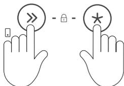
Maintenez enfoncées les touches >> et \* simultanément pour verrouiller les commandes.
