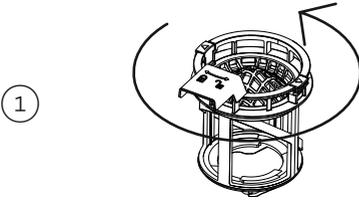
Tournez le filtre dans le sens inverse des aiguilles d'une montre pour le libérer. Soulevez-le pour le retirer.
