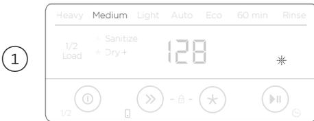
Lorsque le niveau de produit de rinçage est bas, le voyant de produit de rinçage s'allume sur le panneau de commande pour vous rappeler de remplir le distributeur.
