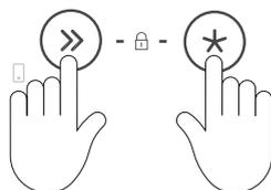
Maintenez enfoncées les touches >> et \* simultanément jusqu'à ce que le lave-vaisselle se déverrouille.
