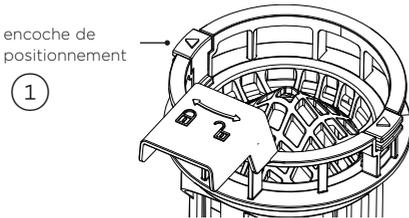
Alignez le capuchon du filtre avec l'encoche sur la base du filtre. Enclenchez-les pour les fixer ensemble.
