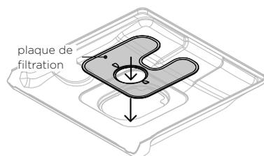
Insérez la plaque de filtration sous les clips de positionnement à l'arrière du drain et poussez fermement pour la remettre en place.
