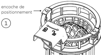
Alignez le capuchon du filtre avec l'encoche sur la base du filtre. Enclenchez-les pour les fixer ensemble.
