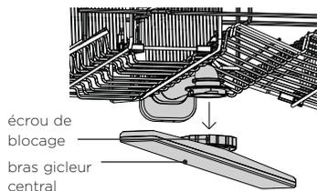
Pour retirer le bras gicleur central, tournez l'écrou de blocage dans le sens des aiguilles d'une montre pour le libérer.
