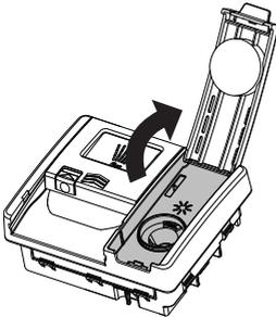
Si un produit de rinçage est nécessaire, remplissez le distributeur de produit de rinçage.
