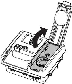
Ouvrez le couvercle et versez le produit de rinçage dans l'ouverture.
