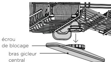
Pour retirer le bras gicleur central, tournez l'écrou de blocage dans le sens des aiguilles d'une montre pour le libérer.
