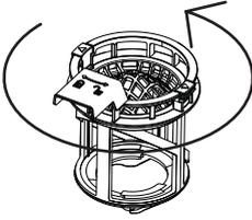
Tournez le filtre dans le sens inverse des aiguilles d'une montre pour le libérer. Soulevez-le pour le retirer.
