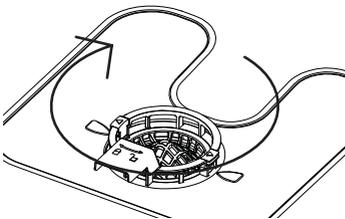
Remplacez le filtre de vidange dans la base du lave-vaisselle. Tournez dans le sens des aiguilles d'une montre pour l'enclencher en place.
