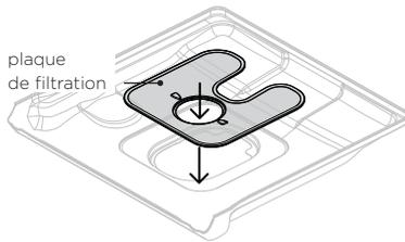
Insérez la plaque de filtration sous les clips de positionnement à l'arrière du drain et poussez fermement pour la remettre en place.
