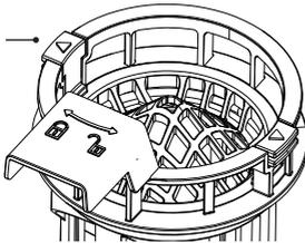
Alignez le capuchon du filtre avec l'encoche sur la base du filtre. Enclenchez-les pour les fixer ensemble.
