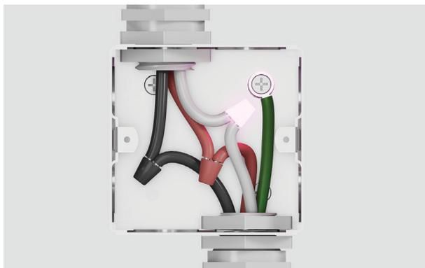
5. Séparez les câbles verts et blancs du four collés en usine. Si la boîte de jonction est mise à la terre, connectez le fil vert à la boîte de jonction en métal avec une vis avant de connecter le câble blanc du four au fil neutre (blanc) dans la boîte de jonction.
