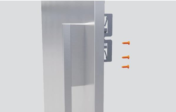
5. Befestigen Sie den Griff mit vier M5x25 Sechskantschrauben an den Blenden.
