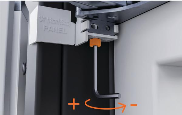
5. Öffnen Sie die Tür und verwenden Sie den mitgelieferten Inbusschlüssel, um den oberen Abstandshalter zu erweitern und einen gleichmäßigen Spalt zwischen Produkt und Alkoven zu schaffen.
