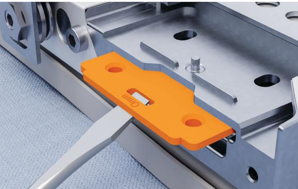
6. Verwenden Sie einen Schlitzschraubendreher, um die Innenplatten zu entfernen. Tauschen Sie sie gegen die andere Seite und achten Sie darauf, dass die abgerundeten Ecken nach innen zeigen.
