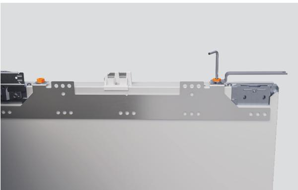
3. Entfernen Sie beide Unterlegscheiben und Muttern und legen Sie sie beiseite. Heben Sie die Blendenhalterung nach außen, um sie zu entfernen.
