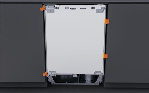
1. Schieben Sie das Produkt so weit ein, bis die Tiefenmessgeräte die Vorderseite des Alkovens berühren. Stellen Sie sicher, dass das Netzkabel nicht eingeklemmt ist.
