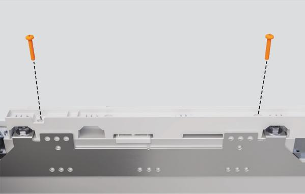
1. Lösen Sie die beiden Kreuzschlitzschrauben, um die obere Abdeckung zu entfernen.
