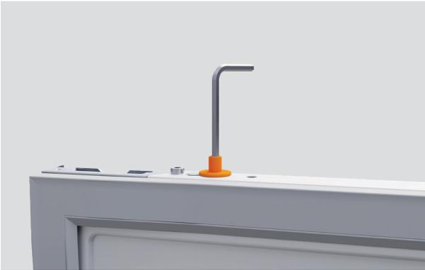
1. Stellen Sie sicher, dass die oberen Befestigungsschrauben gelöst sind und sich in der untersten Position befinden.
