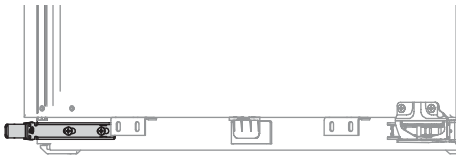
安装橱柜安装支架和间隙调节板
