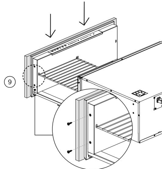
Glissez le cadre de porte afin de réinstaller sur le tiroir et alignez le panneau sur mesure verticalement avec les armoires à proximité.
