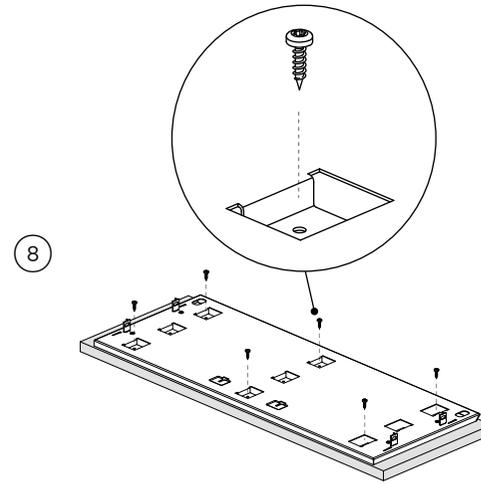
Percez des avant-trous dans le panneau sur mesure, au travers des trous de vis dans le cadre de porte.
