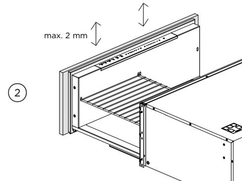
Ajustez le panneau à la hauteur requise, puis resserrez les vis. La hauteur est ajustable dans une plage de 2 mm.
