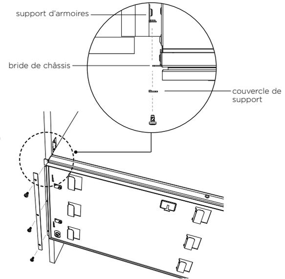
4 Fixez le couvercle de support et la bride de châssis aux supports d'armoires à l'aide de vis à métaux T15 (6x).
