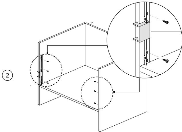
2 Utilisez la pièce d'espacement fournie pour localiser la position de fixation des supports d'armoires à la profondeur adéquate.
