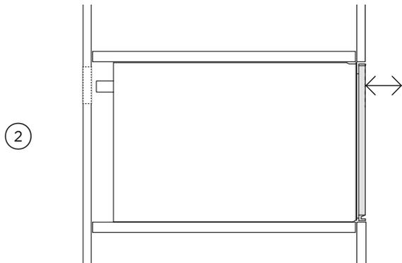
La profondeur est ajustable dans une plage de 4 mm.
