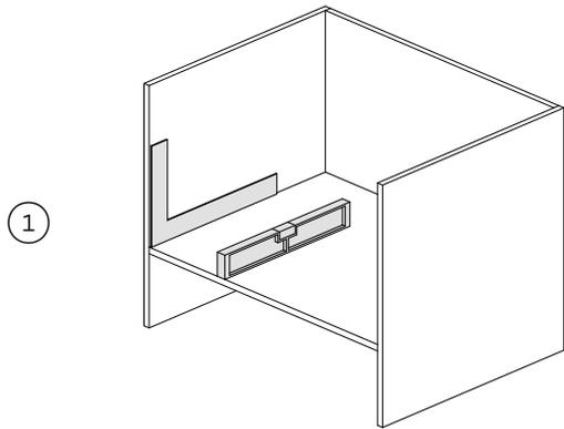
1 Vérifiez la base des armoires à l'aide d'un niveau ou d'une règle.
