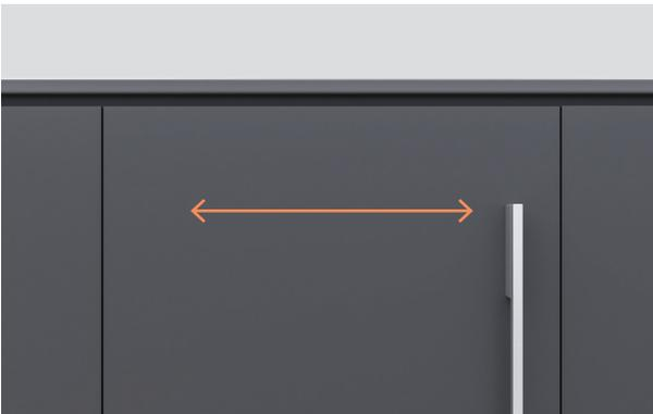
6. Drücken Sie die Blende seitwärts, um sie horizontal zu verstellen. Stellen Sie sicher, dass die Paneele bündig mit der Vorderseite des Schrankes abschließen.
