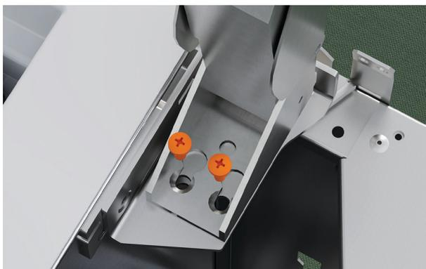
2. Setzen Sie das entfernte obere Scharnier in die unteren Klammern der Halterung ein. Drehen Sie es in Position und befestigen Sie es mit zwei M5x12 Senkschrauben.
