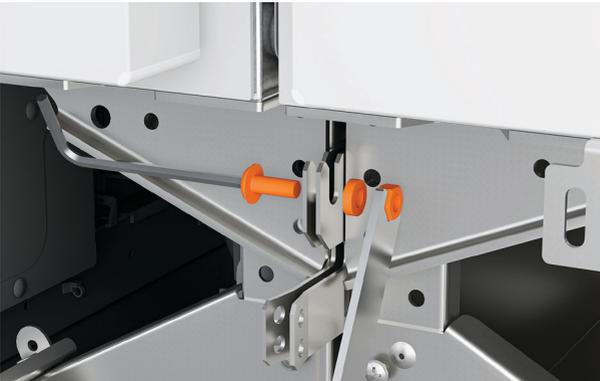
2. Befestigen Sie die unteren Halterungen mit der mitgelieferten M6-Schraube und -Mutter. Mit einem 4-mm-Inbusschlüssel und einem 10-mm-Schraubenschlüssel sichern.
