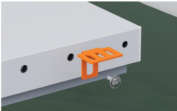
1. Lösen Sie die M6x25-Schraube, um die Türblendenverriegelungshalterung und die Unterlegscheibe von der Unterseite der Tür zu entfernen.
