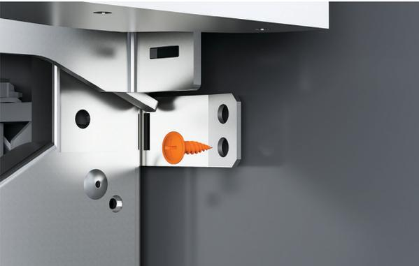
**5.** Befestigen Sie die beiden unteren Seitenhalterungen mit einer Senkschraube 8x16 an jeder Seite an der Seitenfläche des Schrankes.
