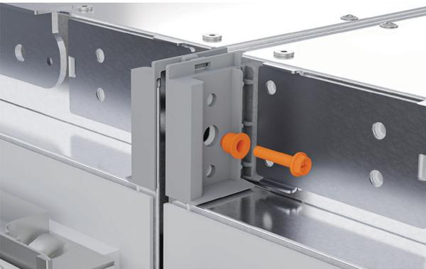
3. Klemmen Sie die oberen Halterungen zusammen, indem Sie die mitgelieferte M5-Schraube und Verbindungshülse anbringen. Mit einem 8-mm-Steckschlüssel und einem Kreuzschlitzschraubendreher festziehen, bis die Hülse bündig sitzt.
