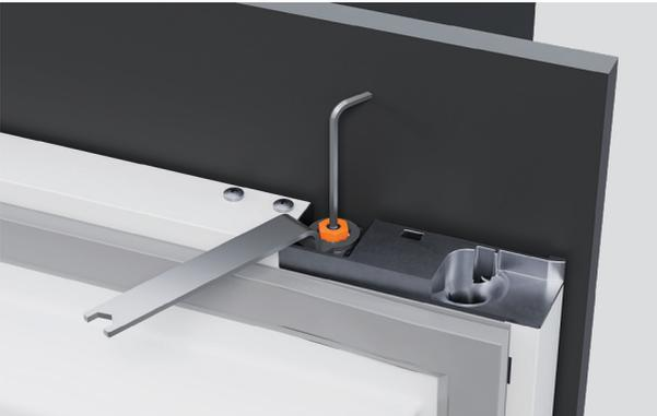
**8.** Ziehen Sie die M8-Unterlegscheiben mit dem mitgelieferten Schraubenschlüssel und dem Inbusschlüssel fest.
