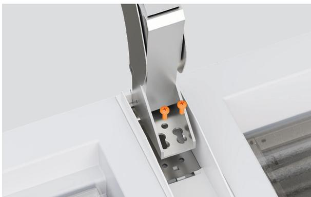
2. Öffnen Sie das mittlere Scharnier und befestigen Sie es mit zwei M6x16 Senkschrauben.
