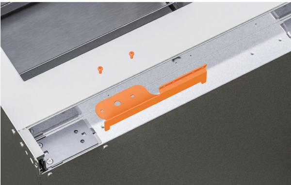
5. Entfernen Sie auf der Gegenseite die Nischenhalterung, indem Sie die M6x16-Senkkopfschrauben lösen.
