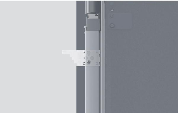
**2.** Markieren Sie die Stufe des Tiefenmessgeräts auf den Schrankseiten der Türen, basierend auf der Dicke der Türblende.
