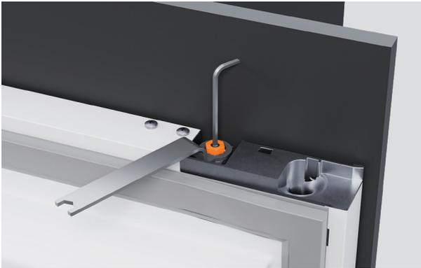
5. Ziehen Sie die seitlichen Schrauben und die oberen M8-Unterlegscheiben mit dem Schraubenschlüssel und dem L-Schlüssel aus dem Installations-Kit locker an.
