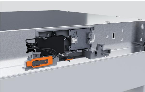
6. Befestigen Sie den Hallsensor im Sensorgehäuse in der Tasche, die der Mittellinie des Schanks am nächsten liegt, bevor Sie die Kabelbaumhalterung in die Gabeln drücken.
