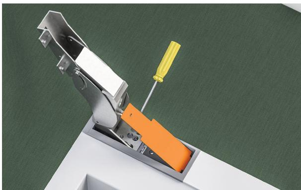
1. Öffnen Sie das obere Scharnier vollständig und entfernen Sie die Abdeckung der Scharniertasche mit dem Schlitzschraubendreher.
