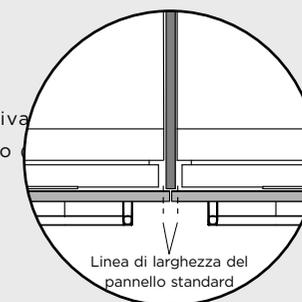
Il numero massimo di apparecchi per cavità è tre. Se sono necessarie due cavità, è possibile utilizzare un distanziatore con pannelli più larghi.
