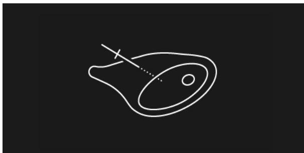
4. Inserte el sensor en la parte más gruesa del plato, evitando la grasa y el hueso en la carne. Asegúrese de que la punta del sensor no sobresalga del otro lado de los alimentos ni toque los utensilios de cocina.
