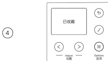
显示器显示设置已保存。此程序现在显示♥图标，表示此程序已收藏。
