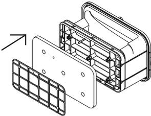
重新安装泡棉过滤网，然后用支架固定泡棉过滤网。
