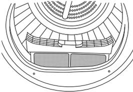
门上的线屑过滤网位于门上（底部）。
