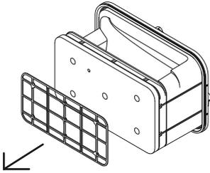
拆卸冷凝器过滤网上的泡棉过滤网固定支架。
