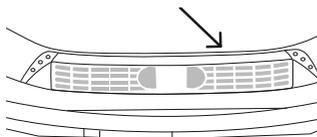
找到线屑过滤网后面的金属传感器。
