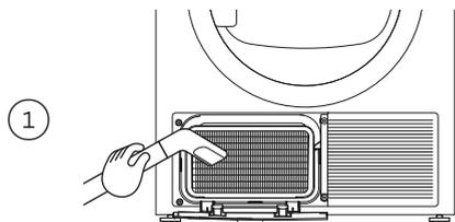
如果蒸发器盘管表面脏，用带除尘刷或缝隙吸嘴的吸尘器仔细清洁蒸发器盘管表面。动作要轻柔，切勿弄弯精细金属散热片。
