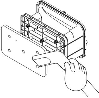
取下泡棉过滤网，然后用带缝隙吸嘴的吸尘器吸走上面的线屑。
