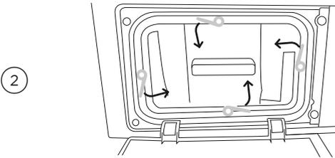
转动四个冷凝器锁杆90度角拉出冷凝器过滤网。
