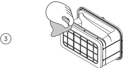
用手、抹布或带缝隙吸嘴的吸尘器清除过滤网表面聚集的线屑。
